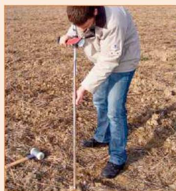
2. Le principe de l'AGRO Sonde®VM permet un échantillonnage direct sur les 3 horizons. La dissociation de l'enfoncement et du prélèvement évite ainsi tout risque de mélange d'horizon.
