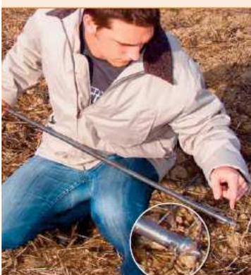
1. L'AGRO Sonde®VM est munie d'une ogive interchangeable en fonction de la nature et de l'humidité des sols qui facilite l'enfoncement en réduisant les frottements.
