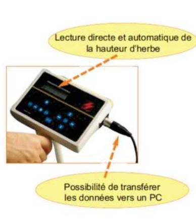
L'HerboMETRE® indique une hauteur d'herbe compressée par le plateau, tenant compte de la hauteur et de la densité du couvert végétal. La lecture se fait grâce à la règle graduée, sur laquelle figure les conseils : pâturage, sortie conseillée, fauche conseillée...
