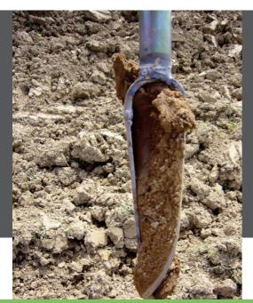
Tarière agronomique hélicoïdale, polyvalente, robuste et légère (1,3 Kg) de 125 cm. Sa longueur et la robustesse de sa lame permettent de descendre à 90 cm en 6 horizons de 15 cm. Son diamètre de 50 mm est le mieux approprié au prélèvement de reliquats azotés. Convient pour tous les types sols et quelque soit l'humidité.
