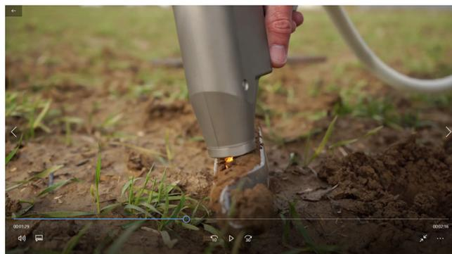
*Le spectromètre envoie un rayonnement proche infrarouge sur l'échantillon de terre. C'est l'énergie lumineuse captée par l'échantillon qui permet de calculer sa composition.*
