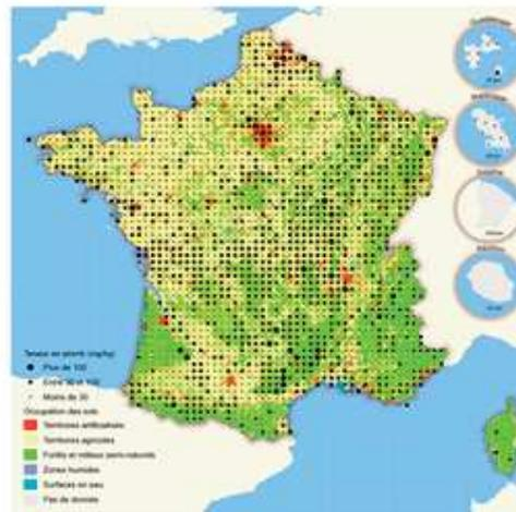
Figure 2 : Teneurs totales en plomb dans les sols mesurées sur la période 2000-2009, de 0 à 30 cm de profondeur. Source : Gis Sol (RMQS), 2009.
