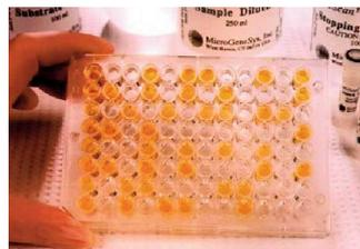
Test ELISA – Réaction colorimétrique
