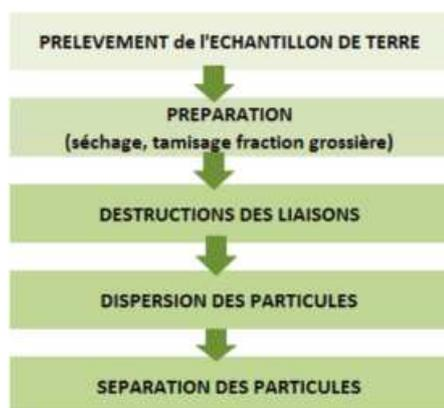
Figure 2 - Schéma simplifié d'une analyse granulométrique
