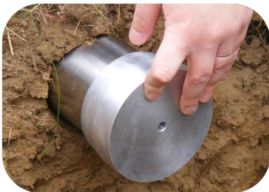
Le prélèvement de cylindres de sol est nécessaire afin de mesurer avec précision la densité apparente du sol.
